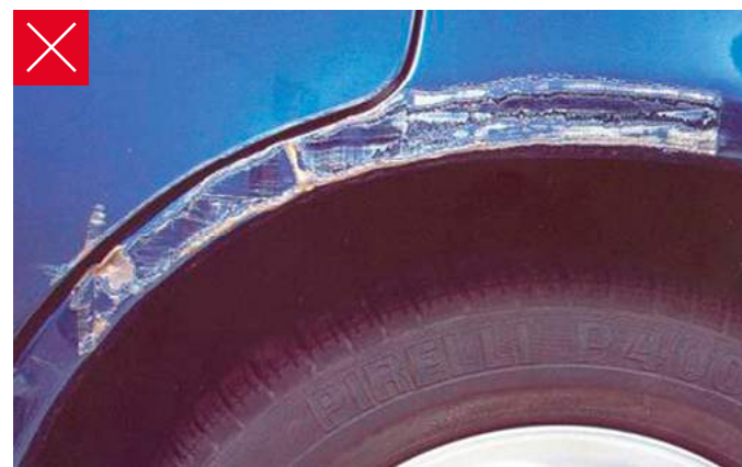
Ein einziger Kratzer von mehr als 100 mm, der eine Neulackierung erforderlich macht oder mehr als ein Blech betrifft
