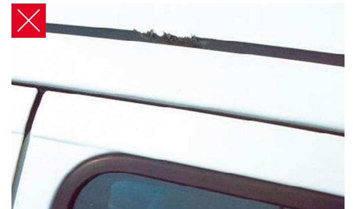
Abrieb an der Gummileiste, der sich negativ auf das Erscheinungsbild des Teils auswirkt
