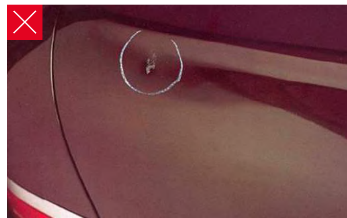
Delle, die Lackierarbeiten erforderlich macht
