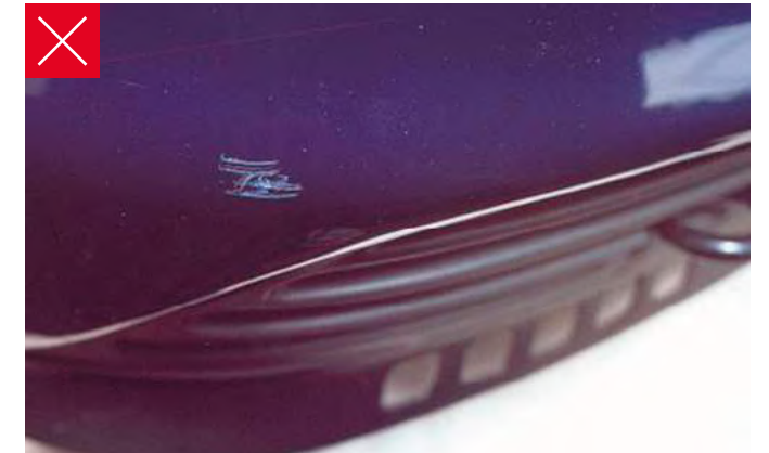
Kratzer am Stoßfänger bis auf den Grundwerkstoff
