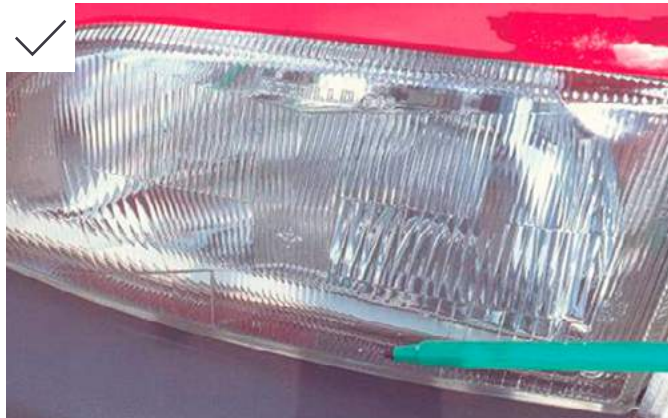
Streuscheibe mit geringfügiger Absplitterung ist akzeptabel, falls es sich nicht negativ auf das Erscheinungsbild des Fahrzeuges oder den Wirkungsgrad der Leuchte auswirkt
