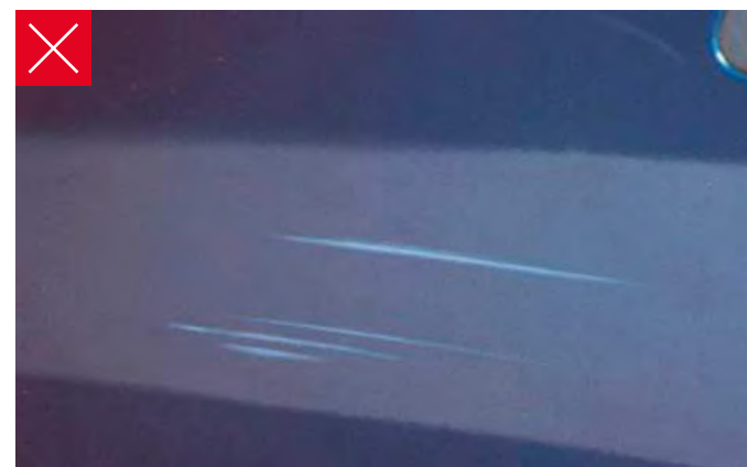
Dellen, die Ausbeul- und Lackierarbeiten erforderlich machen
